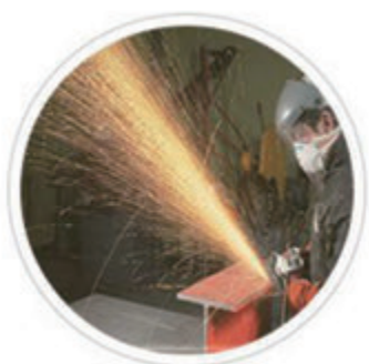
机械摩擦清洗法 清洁度高，但易损伤基材
